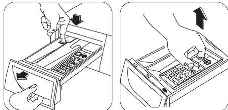
Aby čištění bylo snazší, lze vrchní díl komory na přísady vyjmout.
