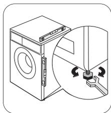
Podle potřeby zkontrolujte správné vyrovnání pomocí vodováhy.
