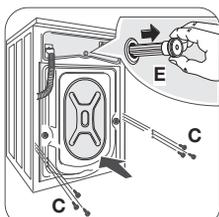
5. Снимите скобу **D**, закрутите шесть маленьких болтов **C** и снимите пластиковую шайбу **E**
